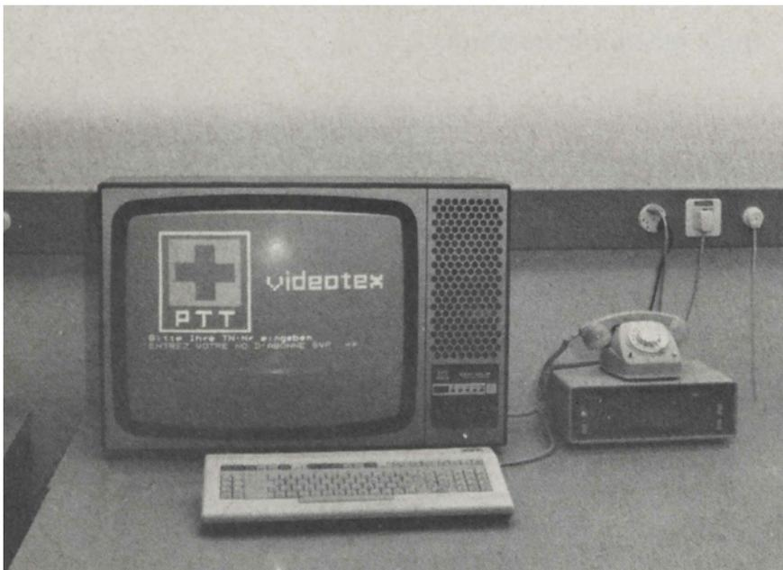
Abb. 3: Eine Videotex-Anlage mit Fernsehgerät, Tastatur, Modem und Telefon, 1979.
