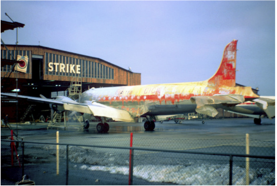
Abb. 6: Wartungsbedürftig: Nach einem Einsatz fürs Rote Kreuz wird die »Unterwalden« abgelaugt und revidiert, 1964.
