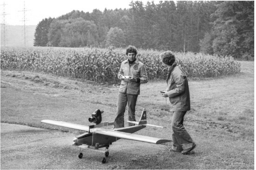
Abb. 8: Ein altes Modellflugzeug diente 1978 in Kleine Freiheit als Träger für die Kamera, um Aufnahmen aus der Luft zu erstellen.
